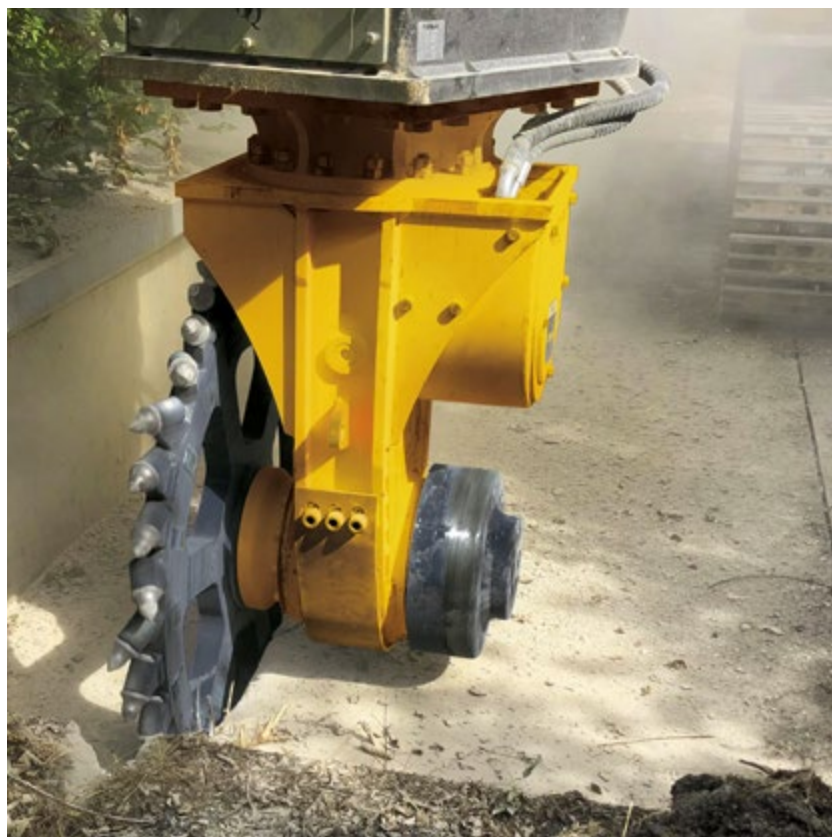
Řezání úzkých žlabů pro potrubí či kabely jedním průchodem.
