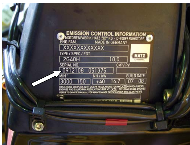
Obr.5 Výrobní číslo motoru Hatz
