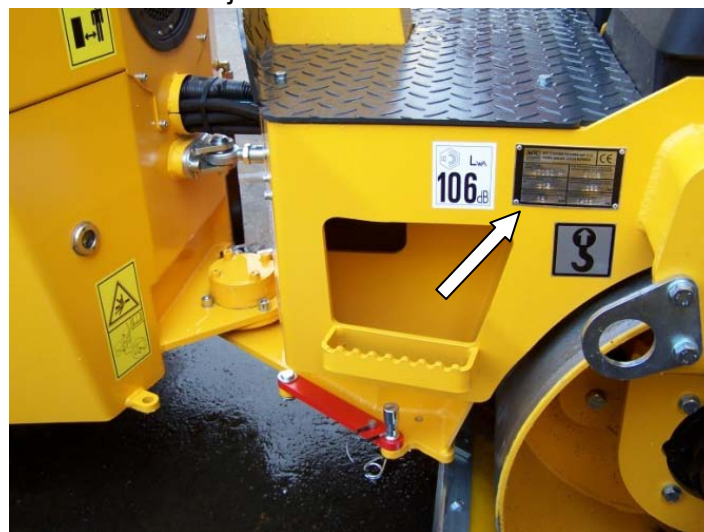
Obr.2 Umístění výrobního štítku stroje
